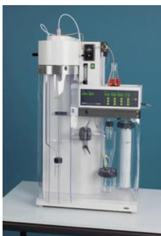
Figura 16 – a) Equipamento de Spray-dryer Büchi modelo B290. b) Diagrama esquemático dos componentes. Legenda: 1 – Entrada do gás de secagem; 2 - Aquecimento; 3 - Sensor de temperatura da entrada de ar; 4 – Atomizador de entrada dos dois fluidos; 5 – Câmara de secagem; 6 – Sensor de temperatura da saída de ar; 7 – Ciclone; 8 – Vaso de recolha do produto final; 9 – Aspirador. [109]
