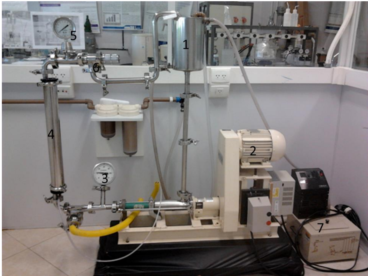
Figura 14 – Montagem experimental da unidade piloto de Nanofiltração (NF). Legenda: 1 - Tanque de alimentação, 2 - Bomba, 3 - Termómetro, 4 – Módulo de membrana de NF, 5 - Manómetro de pressão, 6 - Válvula, 7 - Banho de água.
