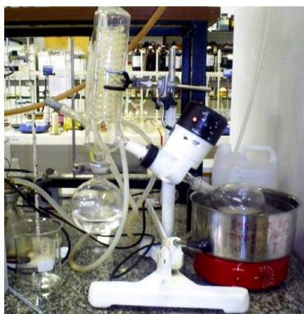
Figura 15 – Montagem experimental utilizada na evaporação a vácuo. Roto-evaporador ou evaporador rotativo da Fisatom modelo 801.
